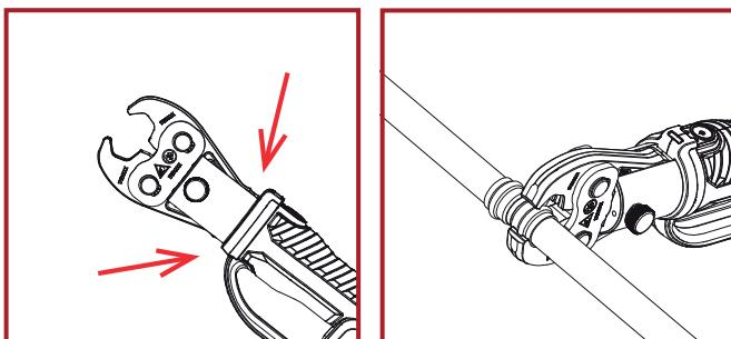
Нажмите кнопку «ПУСК» и выполните соединения. В случае ошибки, нажмите кнопку принудительного реверса и вручную верните поршень в исходное положение. По окончании цикла опрессовки, поршень автоматически вернётся в исходное положение. Снимите пресс-насадку с фитинга.
